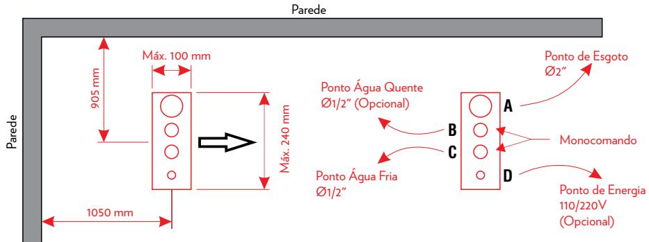
A (Ponto de Esgoto Ø2")- Altura ideal para encanamento referente ao piso é de 50mm.
